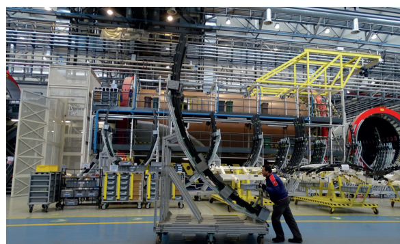
Posizionamento frame aerostutture
